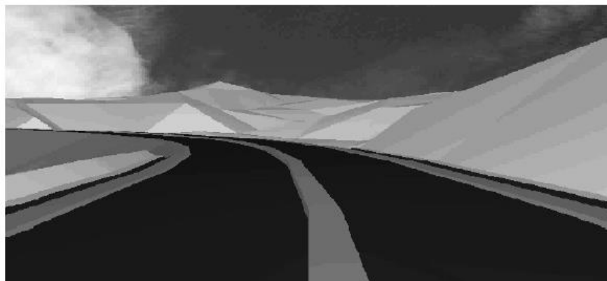
Figura 25: Rodovia projetada e visualizada a partir de MDE na estrutura TIN, com efeito de sombreamento.
